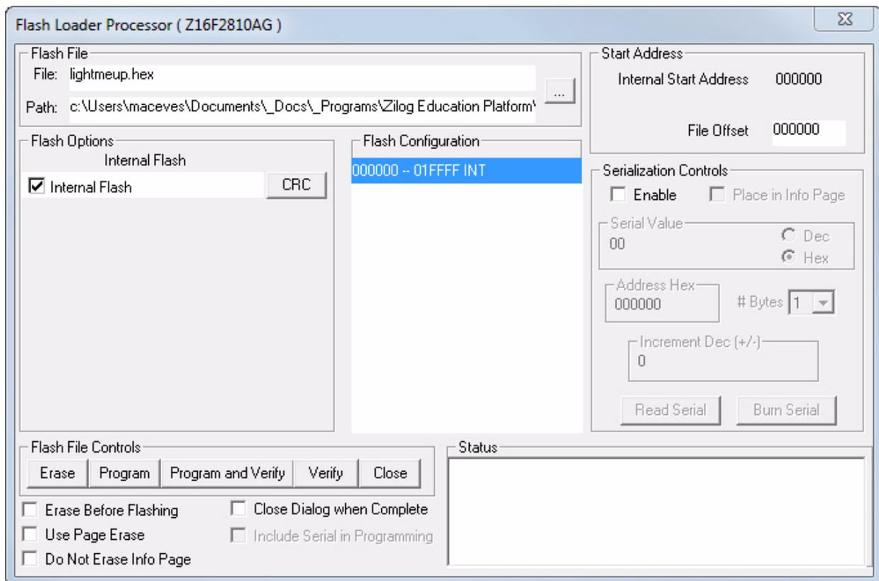
**Figure 28. Flash Loader Screen**
