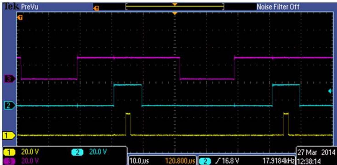
Figure 21. Alternate-Reverse Space Vector Modulation PWM Pattern
