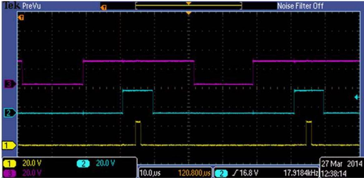
Figure 17. Alternate-Reverse PWM Switching Pattern
