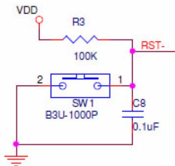
**Figure 16. The Reset Circuit**
